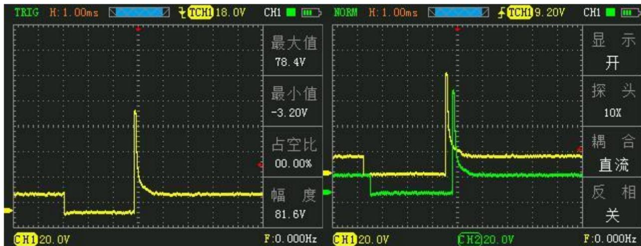
图 13 饱和开关型汽油喷油嘴（电压、电流）
