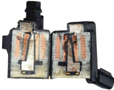
点火线圈横截面（内侧为次级线圈 外侧为初级线圈）
