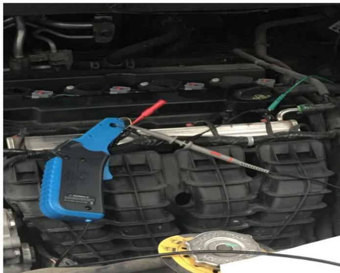
图3 电流钳的使用方式
